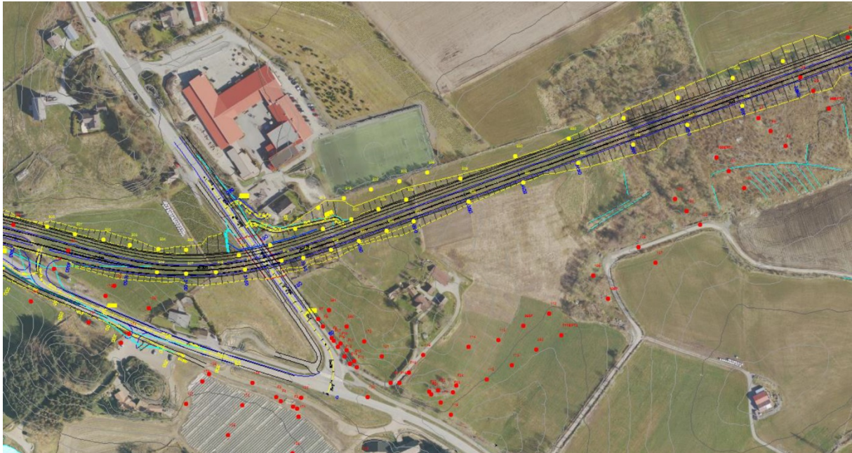
Figur 10 Det er utført supplerende undersøkelser (gule punkt) i forbindelse med utredning av diagonal Nord. Røde punkt er fra grunnundersøkelse utført i forbindelse med utarbeidelse av opprinnelig planforslag (Statens vegvesen 2018).
