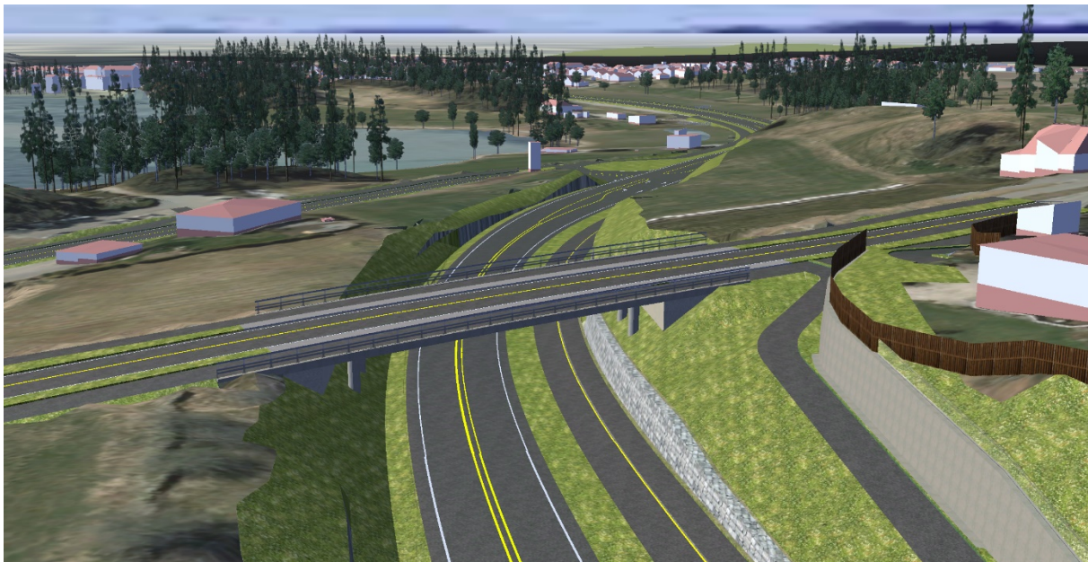
Figur 17 Kyrkjeveien med tosidig gang- og sykkelveg legges på bru over ny fv. 409. Det er foreslått natursteinsmur langs sykkelveg med fortau, mens det langs gang- og sykkelvegrampe er vist betongmur for å redusere terrenginngrepet mot nord (gnr./bnr. 61/48). Standpunkt i modell er fra diagonalen mot vest.
