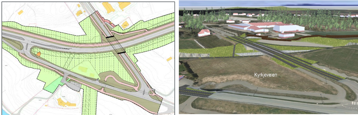
Figur 15 Kyrkjeveien føres på bru over ny TKV, og eksisterende undergang ved Kvernevikveien opprettholdes. 3D-illustrasjon til høyre i figuren illustrerer brua, sett fra sør mot nord.
