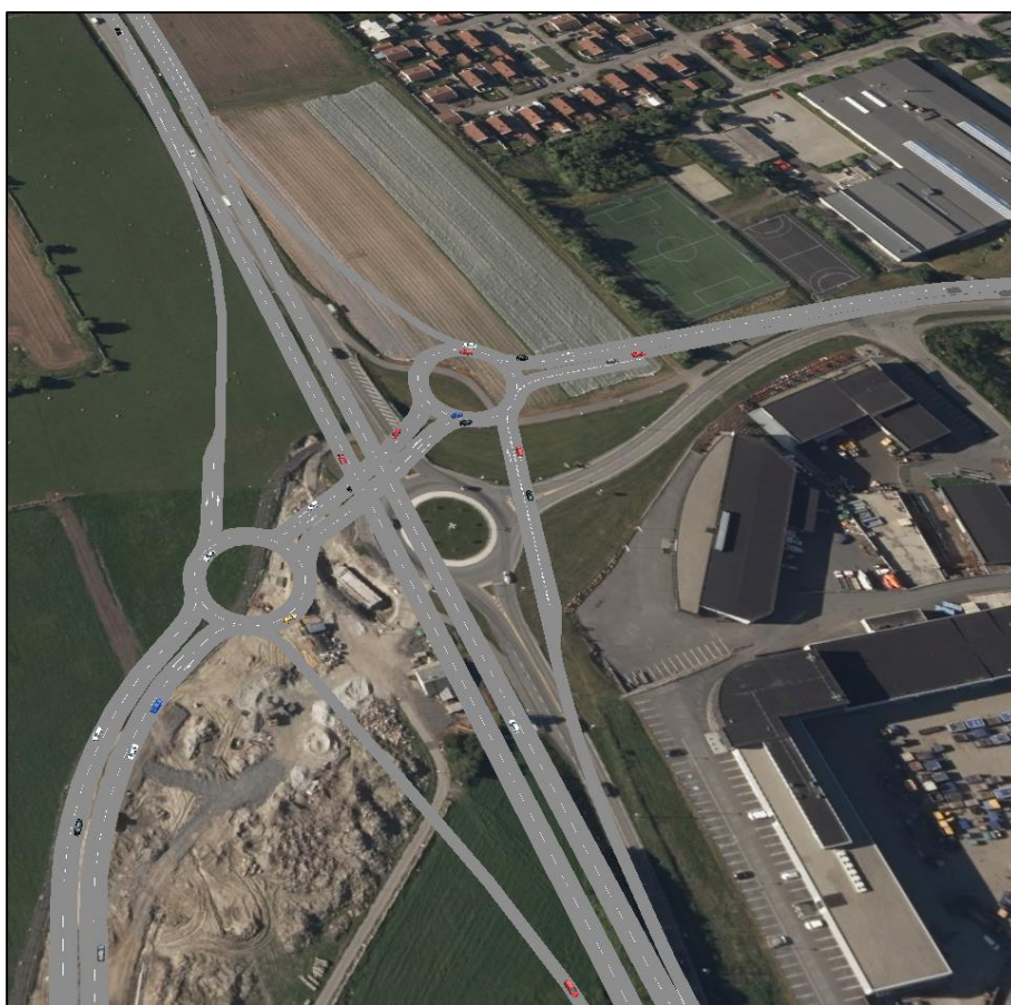
Figur 28 Simuleringsresultat etter ca. 30 minutter i morgenrush, Finnestadkrysset, år 2040.
