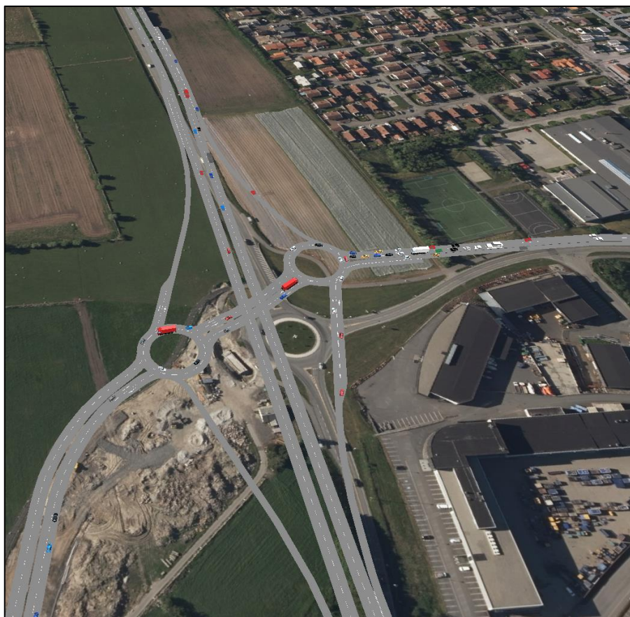
Figur 29 Simuleringsresultat etter ca. 30 minutter i ettermiddagsrush, Finnestadkrysset, år 2040.
