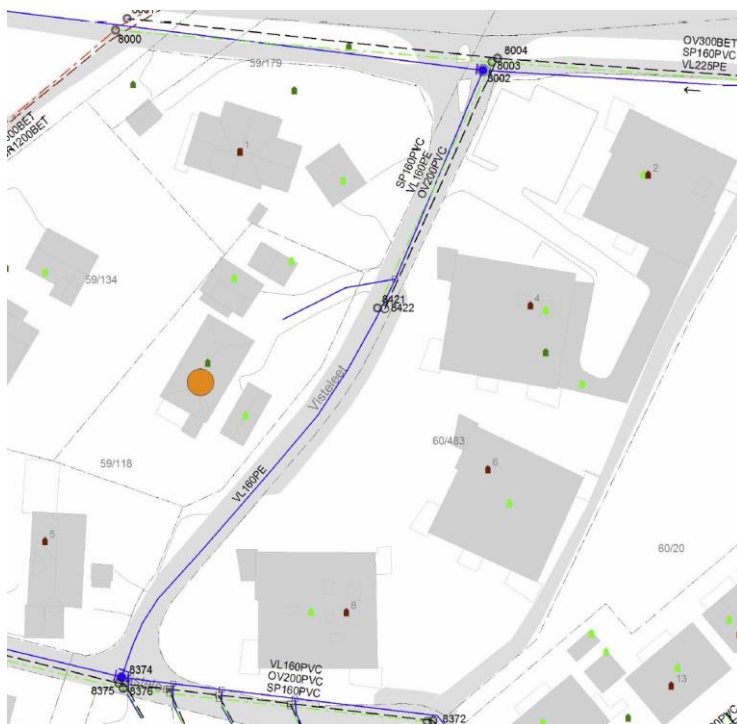
Figur 6 Eksisterende kommunal vann- og avløpsnett
