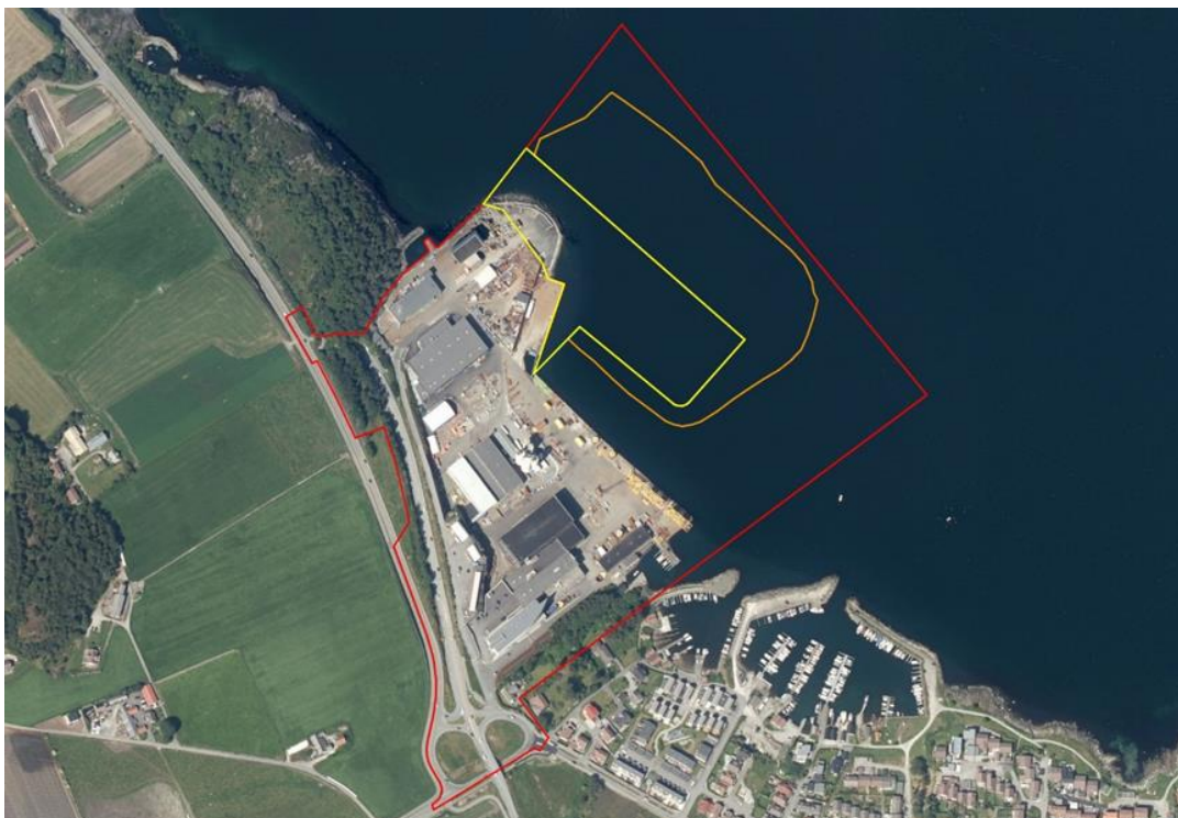
Figur 1: Kart over planområdet. Rød linje viser plangrense. Gul linje illustrere utfylling i sjø (forlengelse av kai) og oransje linje illustrerer skråningsutslaget på havbunnen i forbindelse med utfylling i sjø.
