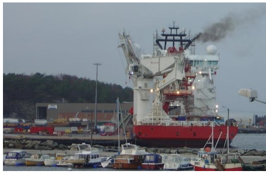
Eksempel på hvordan fartøy vanligvis er fortøyd, dvs. ‘feil veg’
