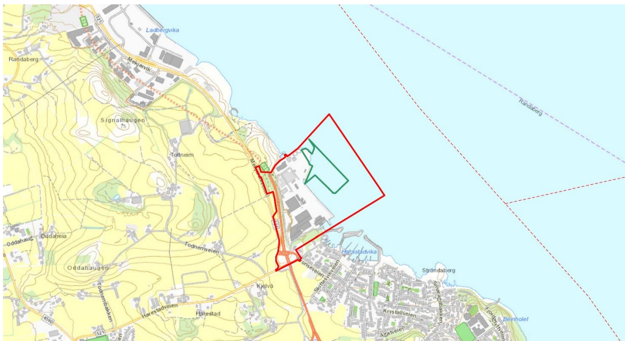
Figur 19 Hovedled og biled slik det er definert av Forskrift om farleder. Planområdet er vist med heltrukket rød linje. Planlagt utfylling er vist med heltrukket grønn linje.
