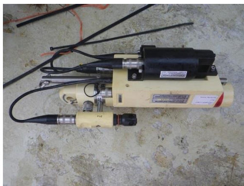
Figur 4. CTD for måling av temperatur, saltholdighet og oksygen i vannsøylen.
